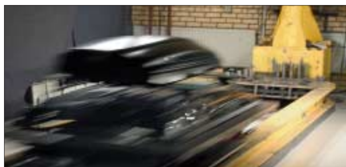
Priekinio susidūrimo važiuojant ne mažesniu kaip 18 km/h greičiu imitavimas.
