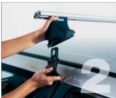
2. Įstatykite tvirtinimo elementą, kad pasigirstų spragtelėjimas, ir įspauskite kojelės guminį paklotą.
