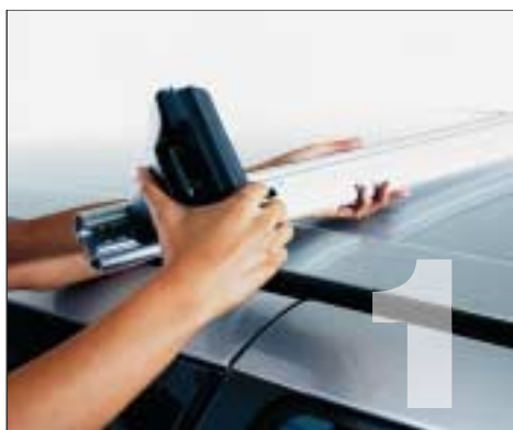
1. Ant krovinių strypo užmaukite kojelę. Pagal strypo skalę sureguliuokite ir reikiamoje vietoje pritvirtinkite kojelę.
