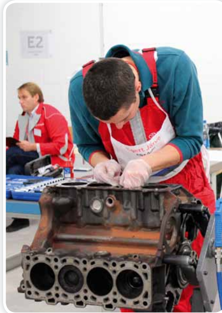
Užduotis: „V8“ variklio bloko techninis matavimas.
