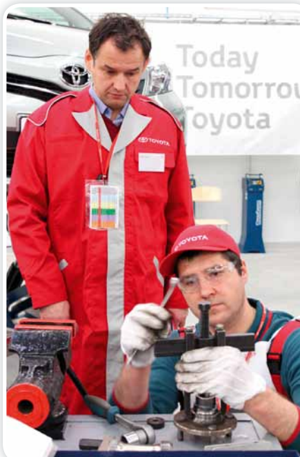
Užduotis: specialūs priekinio rato guolio keitimo darbo įrankiai.
